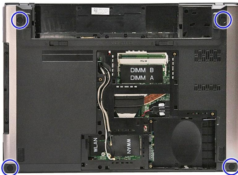
7. Retirez les vis qui fixent le repose-mains à la partie inférieure de l'ordinateur.
