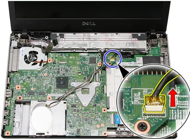
15. Dégagez les câbles de la caméra et d'antenne de leurs guide dans l'ordinateur.
