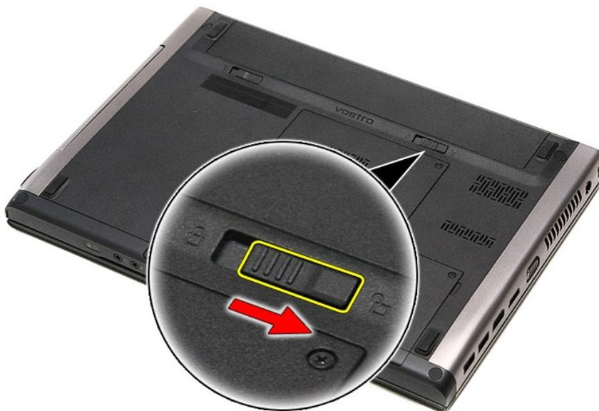
4. Faites glisser en position de déverrouillage l'autre loquet de fermeture de la batterie.
